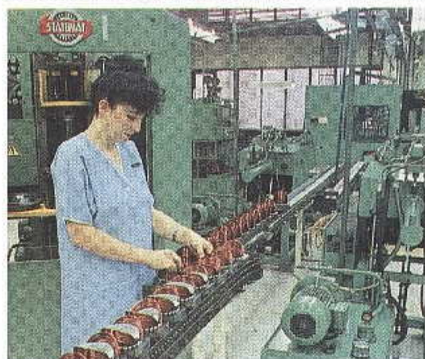
Výroba statorov pre kompresory Production of stators for compressors Statorproduktion für Kompressormotoren Production des stators pour compresseurs производство статоров для компрессоров
